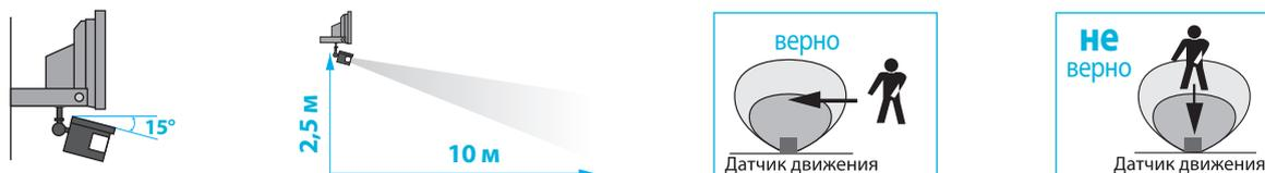
Светодиодный прожектор с датчиком должен быть защищен от прямого попадания осадков, сильного ветра и прямых солнечных лучей.
